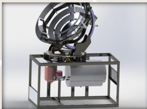
3D модел арматуре са рамом и пратећим носачима
