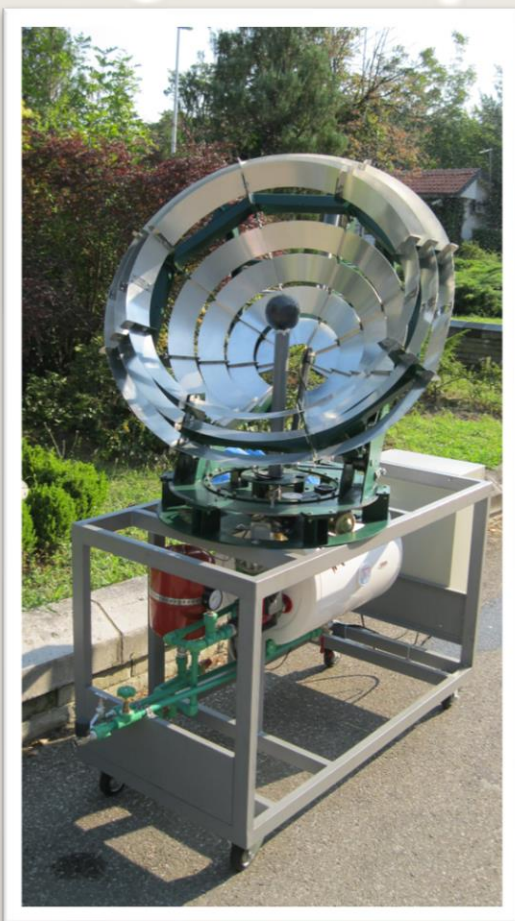
Изглед унапређеног и реализованог соларног концентратора
