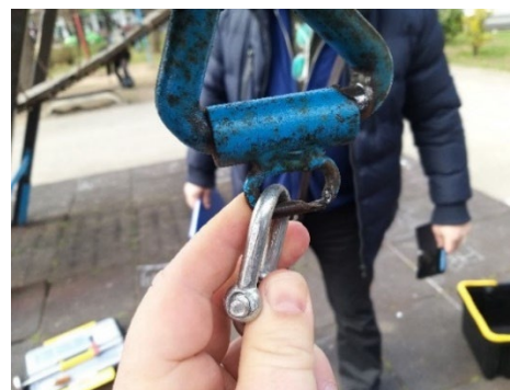
Илустрација 7 – Алка пред пуцање на љуљашци
